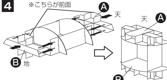
組み立てた補強板1,3と2,3を②で組み立てた補強板4の上
