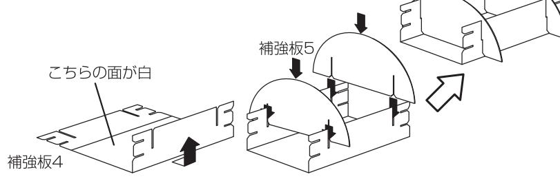
本体を図のように丸めながら折り曲げ、穴3箇所にホックを外側からホック凸を中側から強く差し込み固定する。
