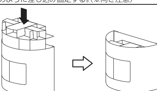
本体の中に組み立てた補強板を入れ込む。
