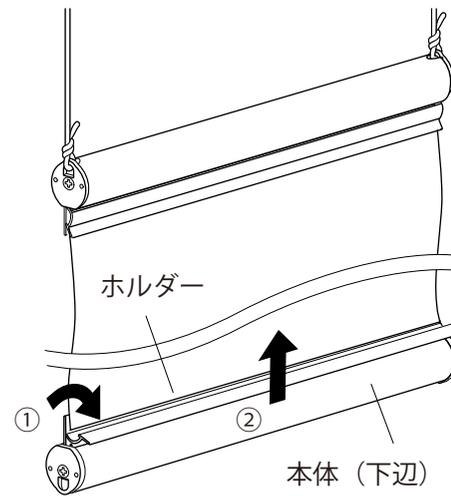
ホルダーを開いて、バナー用紙の下辺を差し込み、ホルダーを閉じ、用紙がしっかり固定されているの確認してセット完了です。
