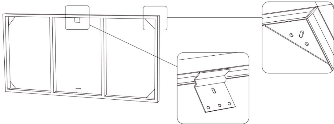
壁面に取り付ける場合は、必要に応じてフレーム取付金具やコーナー取付金具ご使用ください。
