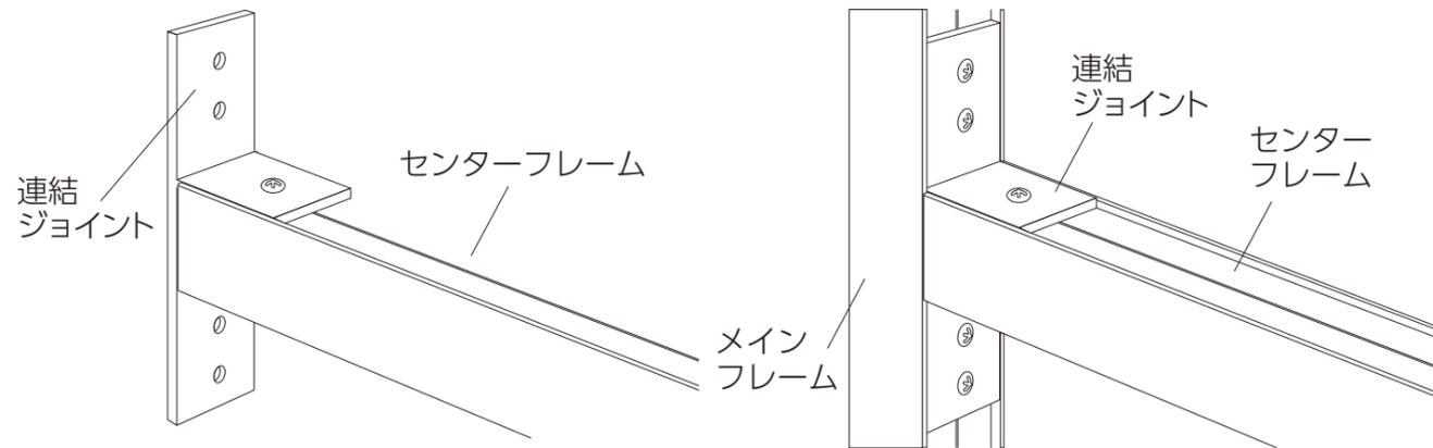
連結ジョイント金具をセンターフレームに取り付けます。
