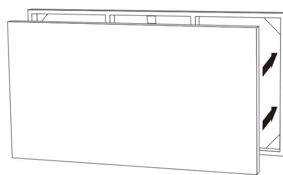
最後にアルミ複合板などの面板をフレームに固定して完成です。
