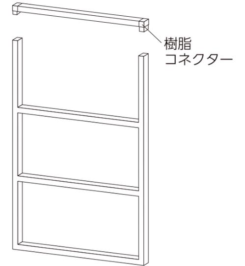
センターフレームを取付けた後に4辺を組み立てます。
