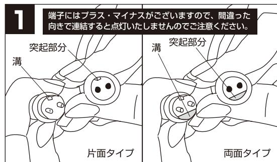
AC アダプターと本体からでている中間コードを連結させます。オス側の突起部分がメス側の溝に合うようにして連結させます。
