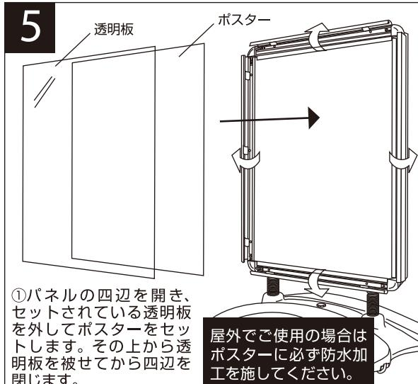
①パネルの四辺を開き、セットされている透明板を外してポスターをセットします。その上から透明板を被せてから四辺を閉じます。
