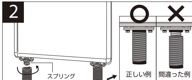
③スプリングを①パネルの下部にある取付部に取付けます。③スプリングは最後までしっかりと、十分にねじ込んでください。
