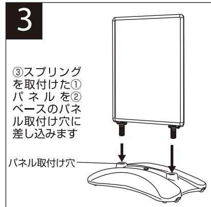
③スプリングを取付けた①パネルを②ベースのパネル取付け穴に差し込みます
