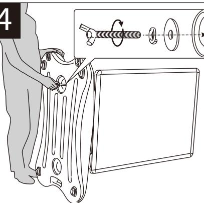
②ベース裏側にある穴に④ボルト、⑤ワッシャー、⑥平座金を取付け、②ベース裏側から貫通した先にあるスプリング底面のボルト穴に取付け、しっかりと締めます。
