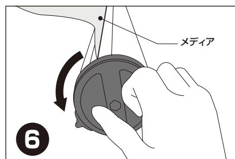
カセット内部にメディアが完全に収納するまで、つまみを反時計方向にゆっくり回します。
