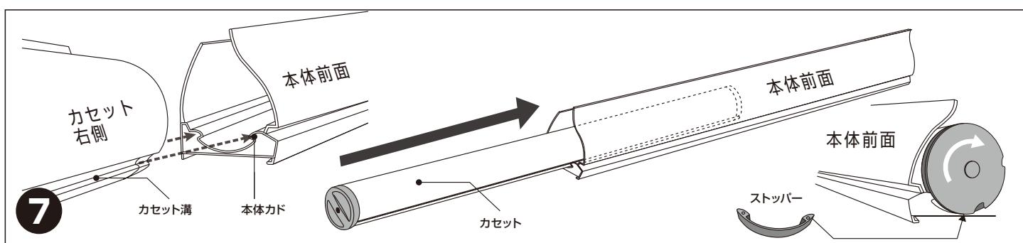
メディアを取り付けたカセットを図の向きにして、カセットの右側から、カセット溝と本体のカドを合わせてまっすぐに差し込みます。差し込んだ後に右側のエンドカバー(外側)を時計周りに回し、ストッパーを取付けてカセットが抜けないようにします。
