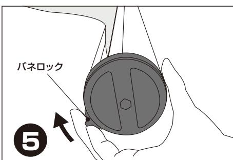
カセットの左側のエンドカバーに付いているバネロックを押しながら上にスライドさせると、バネテンションがロックされます。
