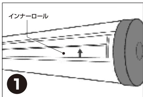
カセット内部にあるインナーロールを、マグネット付きの溝を指し示す赤い矢印が見えるまで回します。
