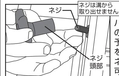
パネル押えを上記の様に取り外して、予備のパネル受けを取り付けると、パネルの2段階表示が可能になります。
