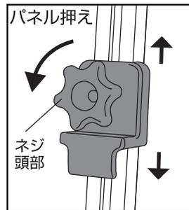
パネル受け・パネル押えのネジ頭部を緩めて位置を調節してください。パネル調節し終えた後はネジ頭部をしっかりと締めて下さい。
