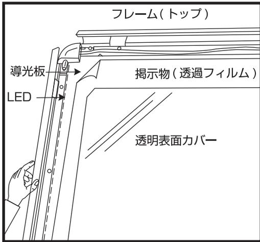
フレームを4辺手で開けます。表面カバーがセットされているので、外してからメディア(ポスターや出力紙など)を表面カバーの内側に装着してから表面カバーとメディアを同時にバックボードの上にセットします。セット後フレームを閉じて完了です。
