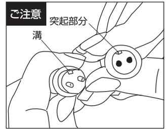
ACアダプターと本体からでているコードを連結させます。オス側の突起部分がメス側の溝に合うようにして連結させます。端子にはプラス・マイナスがございまして、間違った向きで連結すると点灯いたしませんのでご注意ください。
