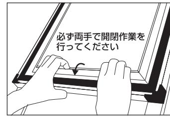
フレームの4辺を手で開けます。透明表面カバーがセットされているので、それを外し、ポスターをセットします。表面カバーをポスターの上にのせて四辺のフレームを同時に両手でしめます。
