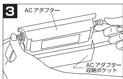
ACアダプターを収納ポケットに収納します
