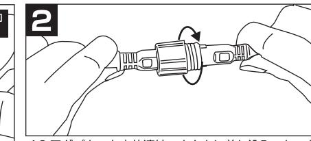
ACアダプターを本体連結コネクタに差し込み、しっかりと最後まで締めます
