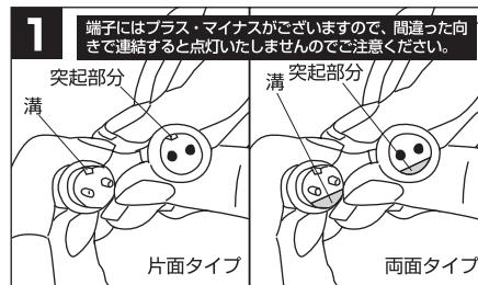
ACアダプターと本体から出ている中間コードを連結させます。オス側の突起部分がメス側の溝に合うようにして連結させます。
