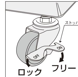
設置時には、ストッパーを固定(ロック)してください。ストッパーのOFF面を押し下げるとキャスターが固定(ロック)されます。反対側のOFF面を押し下げると解除(フリー)されます。
