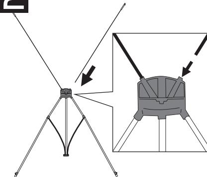
本体フレームの上部にある穴に上部バーを上図のように差し込みます。
