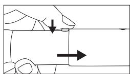
図のように指でロックを押えながら挿入してください
