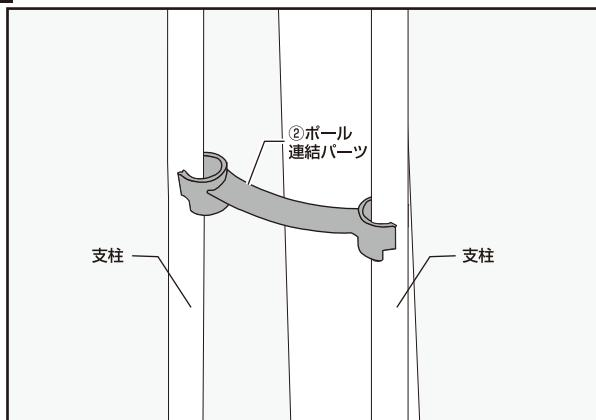
本体のメディアを引き出し、支柱にセットした状態で、2本の支柱をポール連結パーツで連結します。
