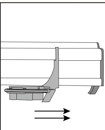
本体接続パーツの平台部分を、バナー本体底面のレール部にはめ込み、図のようにスライドさせてバナー本体の端に取り付けます。
