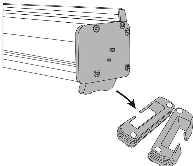
本体底面にある脚部分パーツの溝に取り付けます
