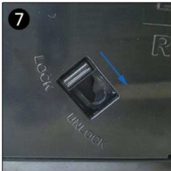
UNLOCK側にボタンを移動させるとロックが外され出力物が飲み込まれます。
