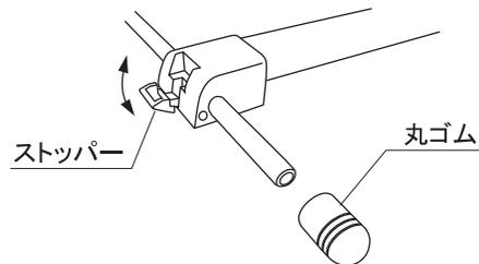
脚部スライド脚の調節により、パネルの傾斜、
