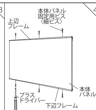
本体パネルと上辺フレームを下辺フレームの両端位置に合わせてのせます。上辺フレームが動かない様に押さえながら、本体パネルのみ左右どちらかに上辺フレーム端の直付け用ビス穴が見える位置まで横スライドさせ、上辺フレーム端を直付け用ビスで壁面に取り付けます。反対側の端も本体パネルを同じ操作で上辺フレームに取り付けて同じく固定します。
