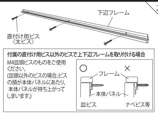
本体パネルを上下辺フレームに左右位置を合わせてのせます。上下辺フレーム側面の穴に合わせて印等をつけて、本体パネル固定用ビスを取り付ける下穴( $\varphi 2.5$ )を電動ドリル等で本体パネルの上下辺に接する側面にあけます。
