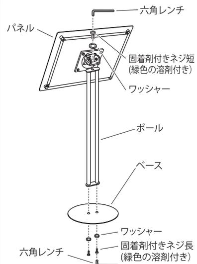
パネルとベースをそれぞれポールにワッシャー・ネジでしっかりと締めて固定します。(ゆるみ防止のため、ポールとベースの固定に固着剤付きネジを使用していますので、いったんネジを締めるとはずしにくくなります。)
