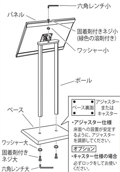
パネルとベースをそれぞれボールにワッシャー・ネジでしっかりと締めて固定します。(ゆるみ防止のため、ボールとベースの固定に固着剤付きネジを使用していますので、いったんネジを締めるとはずしにくくなります。)
