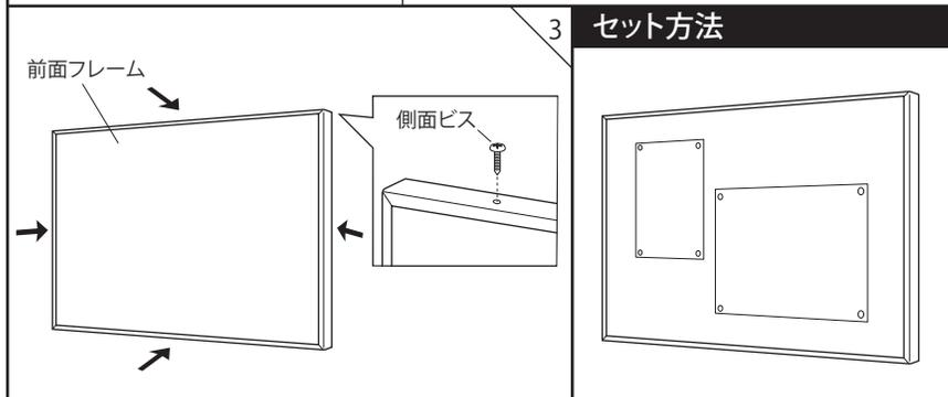
前面フレームを本体フレームにかぶせ、側面ビスをしっかりと締めて完成です。
