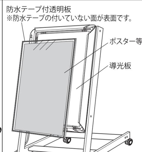
透明板の防水テープの内側にポスターを合わせ、フレームにセットし、フレームを閉じてセット完了です。
